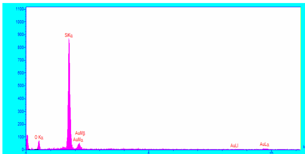
شکل ۱۱- آنالیز نقطه‌ای از بدنه‌ی ST7 (نقطه‌ی ۱)
