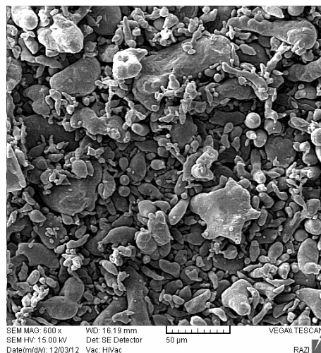
شکل ۱- تصویر میکروسکوپ الکترونی از پودر فلز آلومینیوم.
