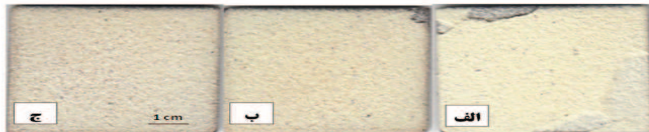
شکل ۱۰- سطح نمونه پوشش درجه‌بندی شده پس از اعمال شوک حرارتی در حالت الف) پوشش دولایه معمولی، ب) پوشش درجه بندی شده سه لایه و ج) پوشش درجه بندی شده پنج لایه
