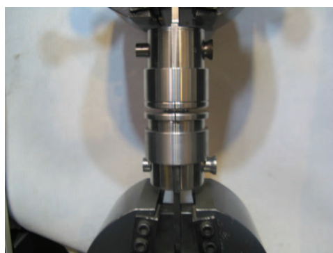
شکل ۶- آزمایش کشش برای نمونه‌های اتصال دهی شده در شکل ۴.
