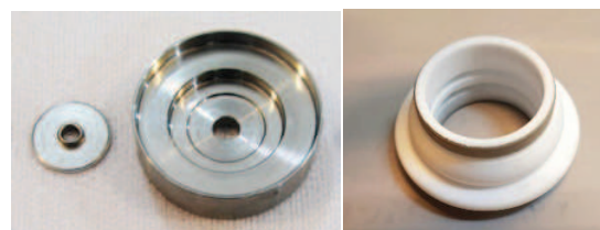
شکل ۳- قطعات ساخته شده برای تولید پوسته تفنگ الکترونی
