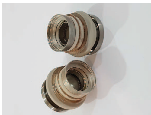
شکل ۱۱- پوسته تفنگ الکترونی بعد از عملیات بریزینگ.
