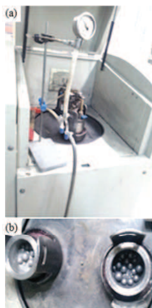
شکل ۲- (a) آسیای گلوله‌ای سیاره‌ای و (b) کپ‌های آسیا شامل گلوله‌ها، براده و پودر
