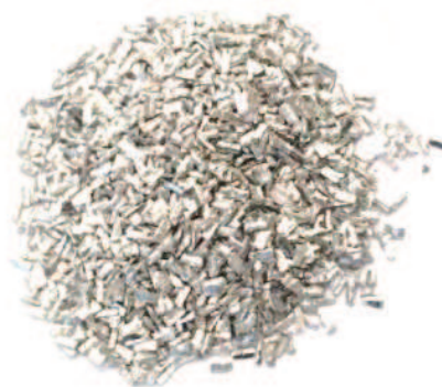
شکل ۱- براده‌های ماشین‌کاری شده‌ی آلیاژ منیزیم AZ91D
