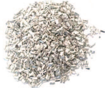
شکل ۱- براده‌های ماشین‌کاری شده‌ی آلیاژ منیزیم AZ91D
