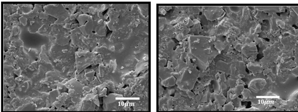
ادامه شکل ۲- تصویر میکروسکوپ الکترونی روبشی از سطح انگوب الف) مرجع نمونه a [۱۳]، ب) نمونه A، پ) نمونه مرجع
