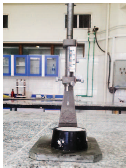
شکل ۱- دستگاه حلقه ویکات برای اندازه‌گیری زمان گیرش.
