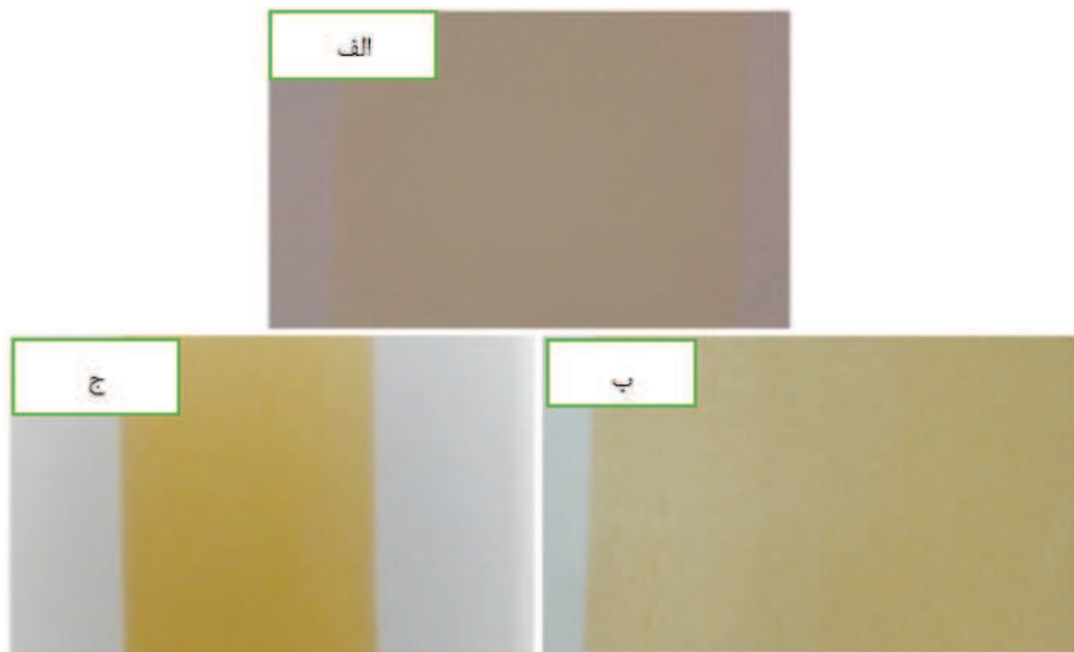
شکل ۵- تصویر سرامیک‌های چاپ شده با رنگدانه‌های ساخته شده با درصد مختلف دوپه Fe_2O_3 (الف) Y1 ، (ب) Y2 و (ج) Y3
