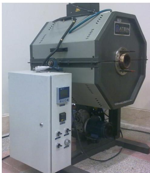
شکل ۲- نمایی از کوره‌ی لوله‌ای با حرکت رفت و برگشتی مورد استفاده در انجام ذوب و یکتواختسازی شیشه‌های کالکوژنیدی
