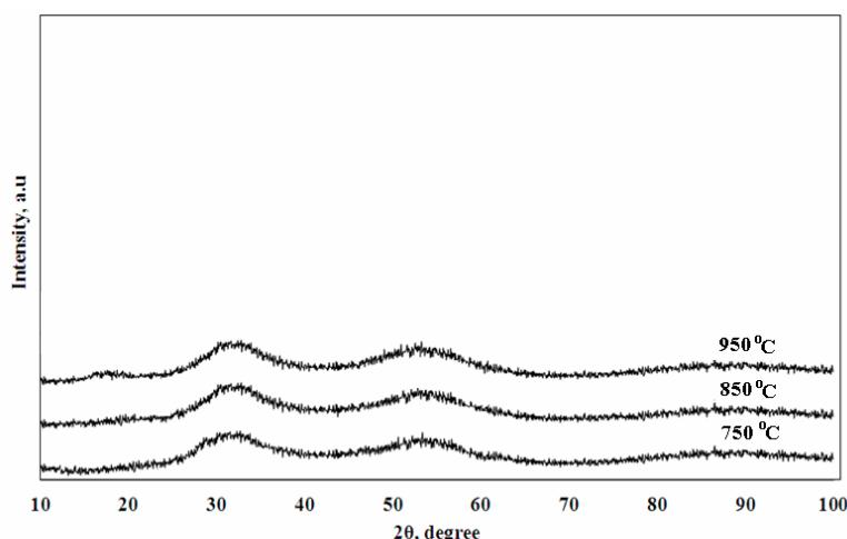
شکل ۴- الگوهای پراش پرتوایکس ترکیب کالکوژنیدی  $\text{Ge}_{33}\text{As}_{12}\text{Se}_{55}$  پس از انجام ذوب در دماهای ذوب مختلف به مدت ۱ ساعت و سرمایش در حمام نمک با دمای ۲۲۰ درجه‌سانتی‌گراد.
