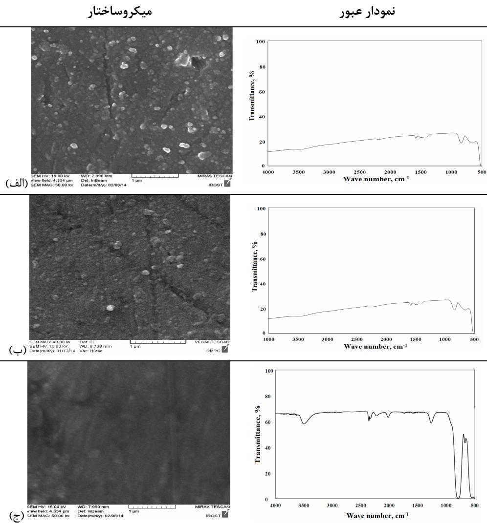
شکل ۶- تصاویر میکروسکوپی الکترونی روبشی و نمودارهای عبور پذیری ترکیب کالکوژنیدی  $\text{Ge}_{33}\text{As}_{12}\text{Se}_{55}$  پس از انجام ذوب در دمای ۹۵۰ درجه سانتی گراد به مدت زمان های (الف) ۱ ساعت و سرمایش در حمام نمک با دمای ۲۲۰ درجه سانتی گراد.
