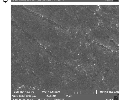
شکل ۵- تصاویر میکروسکوپی الکترونی روبشی ترکیب کالکوژنیدی  $\text{Ge}_{33}\text{As}_{12}\text{Se}_{55}$  پس از انجام ذوب در دمای (الف) ۹۵۰، (ب) ۸۵۰ و (ج) ۲۲۰ ساعت و سرمایش در حمام نمک با دمای ۳۰۰۰ درجه‌ی سانتی‌گراد (در بزرگنمایی ۳۰۰۰ برابر)
