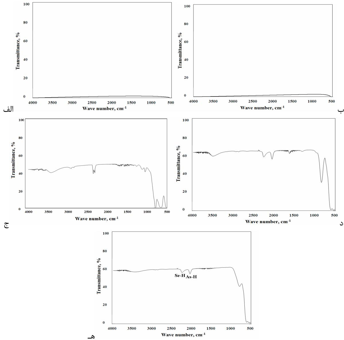
شکل ۸- نمودارهای عبورپذیری ترکیب کالکوژنیدی  $\text{Ge}_{33}\text{As}_{12}\text{Se}_{55}$  در حضور گازرگایی (الف) تیتانیم، (ب) نیوبیم، (ج) کروم، (د) آلمینیوم و (ه) منیزیم.
