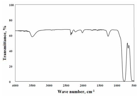
شکل ۷- آنالیزهای ساختاری و عبورپذیری ترکیب کالکوژنیدی  $\text{Ge}_{33}\text{As}_{12}\text{Se}_{55}$  پس از انجام ذوب در دمای ۹۵ درجه‌ی سانتی‌گراد به مدت ۱۰ ساعت و سرماش در (الف) کوره، (ب) آب ( $25^\circ\text{C}$ ), (ج) روغن ( $100^\circ\text{C}$ ), (د) حمام نمک ( $220^\circ\text{C}$ ).
