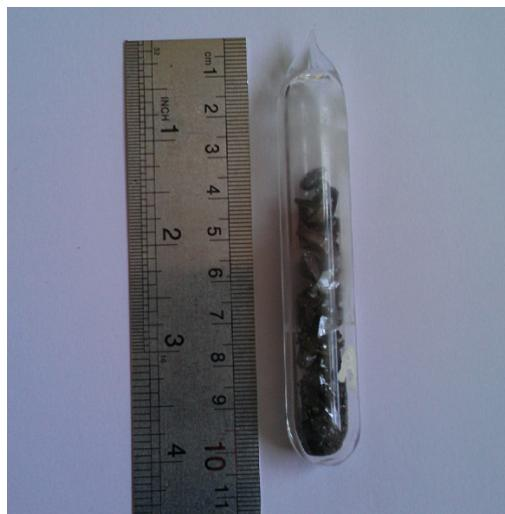
شکل ۱- نمایی از کپسول کوارتز مورد استفاده در ساخت شیشه‌های کالکوژنیدی
