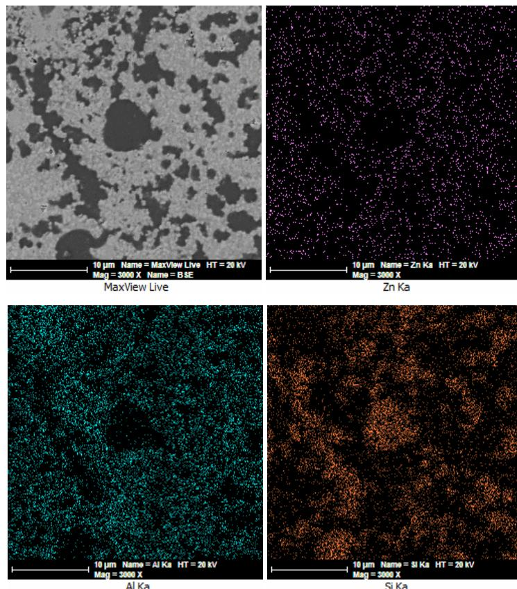
شکل ۹- نقشه توزیع عناصر در ریزساختار کامپوزیت اچ نشده حاوی ۵۰ درصد حجمی شیشه و زینتر شده در دمای ۹۵°C
