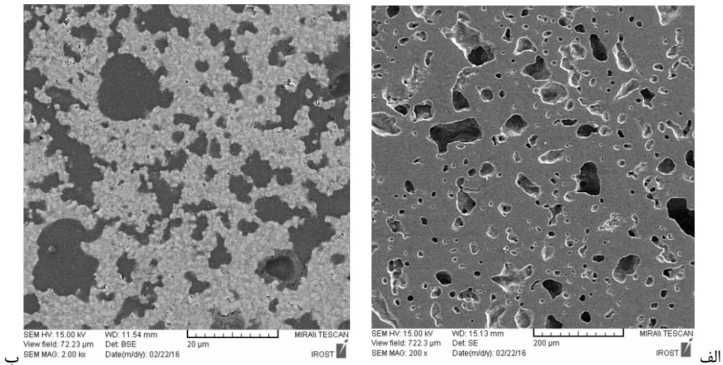
شکل ۸- ریزساختار کامپوزیت حاوی ۵۰ درصد حجمی شیشه و زینتر شده در دمای ۹۵°C (اچ نشده):
