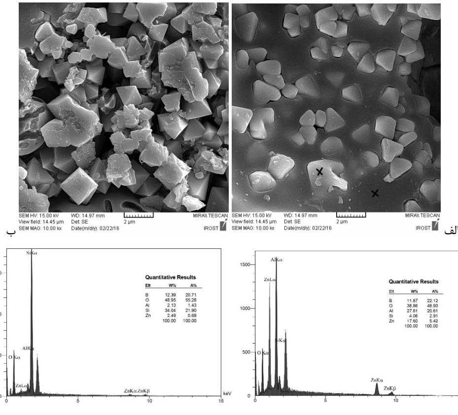
شکل ۱۰- ریزساختار کامپوزیت حاوی ۵۰ درصد حجمی شیشه و زینتر شده در دمای ۹۵۰°C پس از اج شیمیایی:
