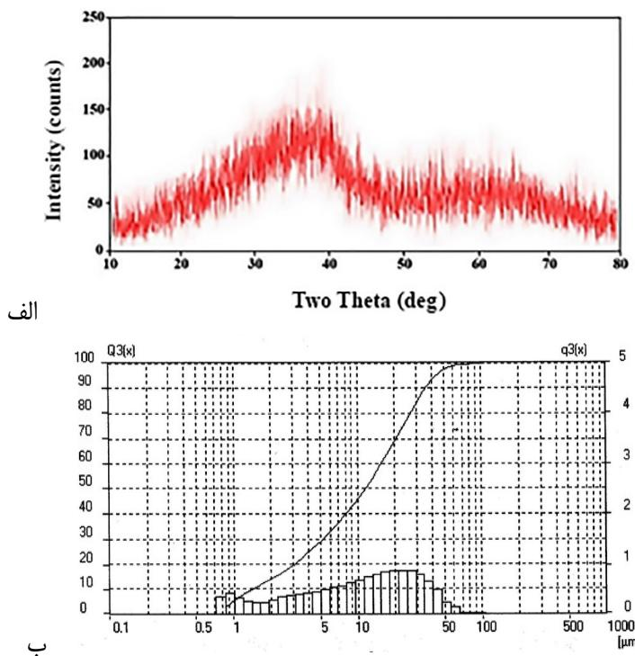
شکل ۲- فریت شیشه تهیه شده در دمای  $1300^{\circ}\text{C}$ :
