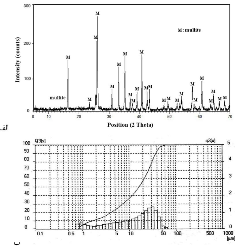
شکل ۱ - مولایت سنتز شده در دمای  $1400^\circ\text{C}$  به مدت ۲ ساعت:
