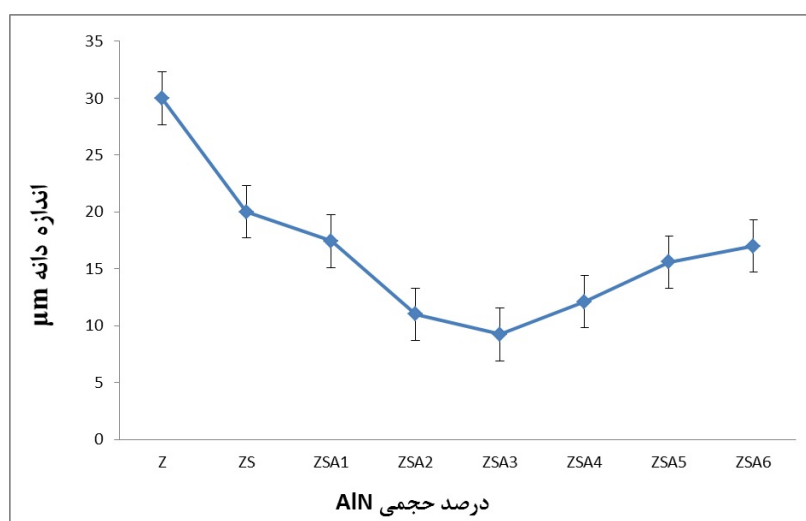
شکل ۱۳- تأثیر درصد حجمی AlN بر اندازه دانه‌های کامپوزیت \text{ZrB}_2\text{-SiC}
