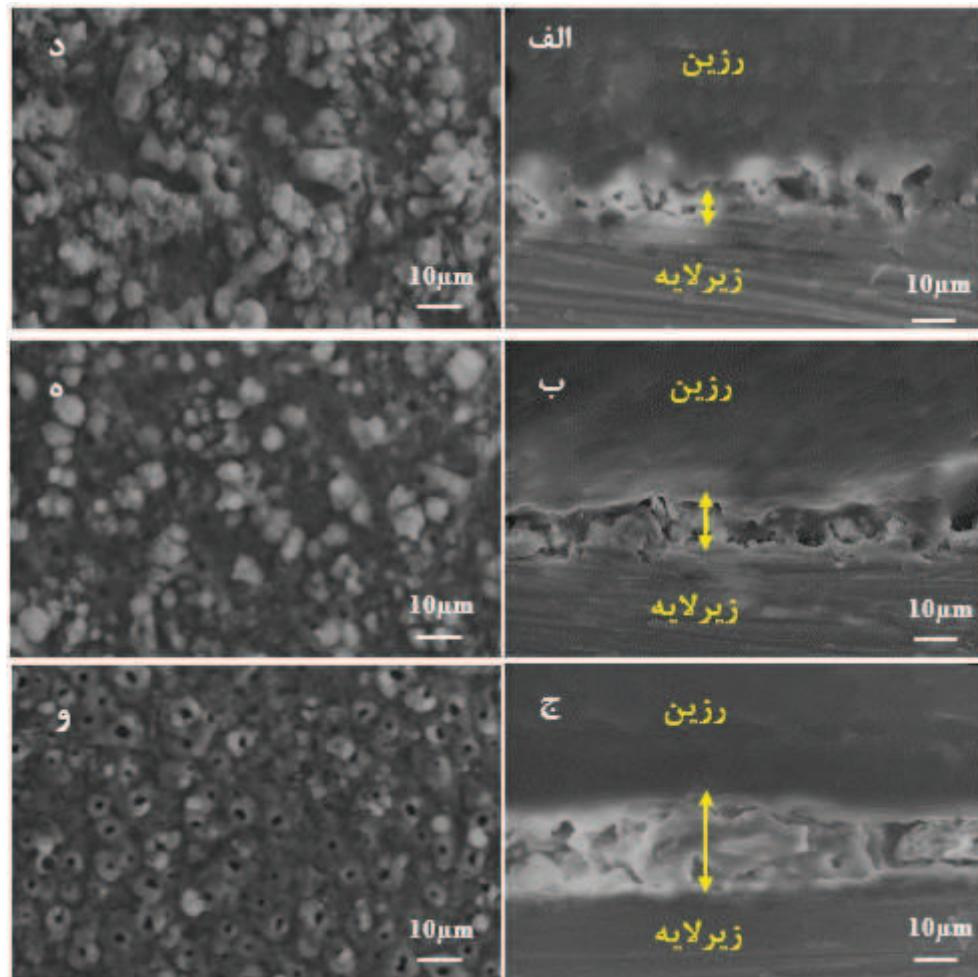
شکل ۳- تصاویر میکروسکوپ الکترونی روبشی سطح و سطح مقطع پوشش‌های حاصل از حمام‌های پوشش‌دهی مختلف (الف، د) ۶ (ب، ۵) ۱۲ (ج، و) ۱۸ گرم بر لیتر.
