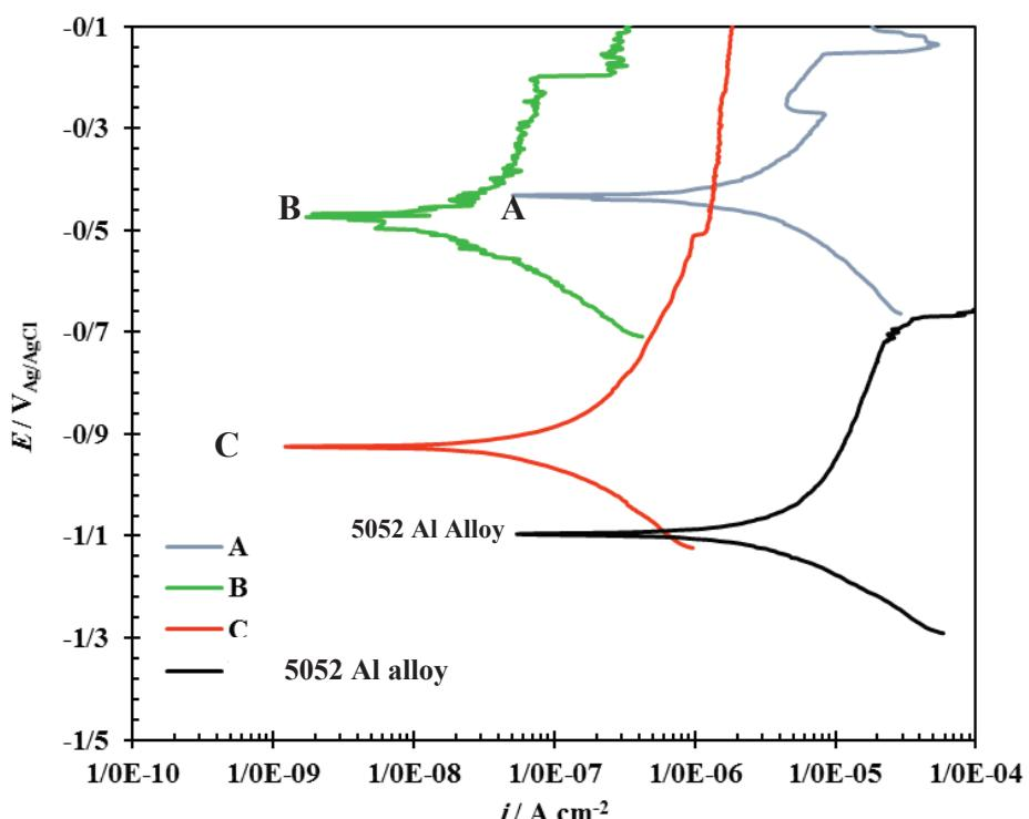
شکل ۶- منحنی‌های پلاریزاسیون پتانسیوودینامیک نمونه‌های بدون پوشش و دارای پوشش در محلول خورنده کلرید سدیم  $3/5$  درصد وزنی.
