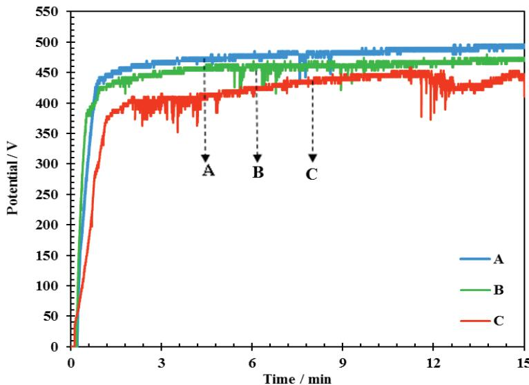
شکل ۱- نمودارهای ولتاژ-زمان نمونه‌های پوشش داده شده.
