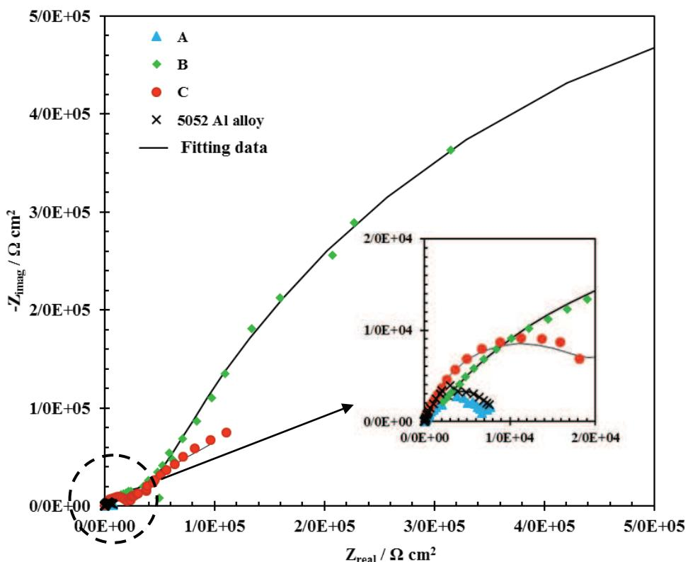
شکل ۴- منحنی طیف‌سنگی امپدانس الکتروشیمیایی نمونه‌های بدون پوشش و پوشش داده شده در غلظت‌های مختلف سیلیکات سدیم.
