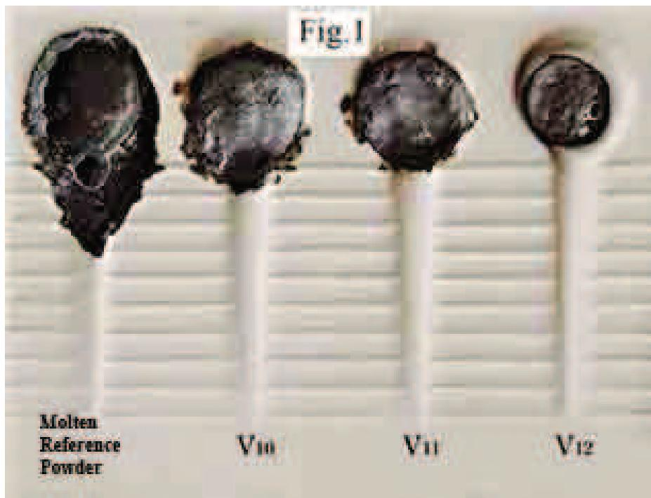
شکل ۲- طرحواره ویسکومتر شیاری نمونه‌های گروه V.
