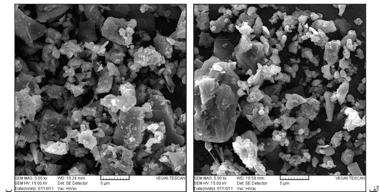
شکل ۱- (الف) تصاویر میکروسکوپ الکترونی از پورهای تحقیقاتی.
