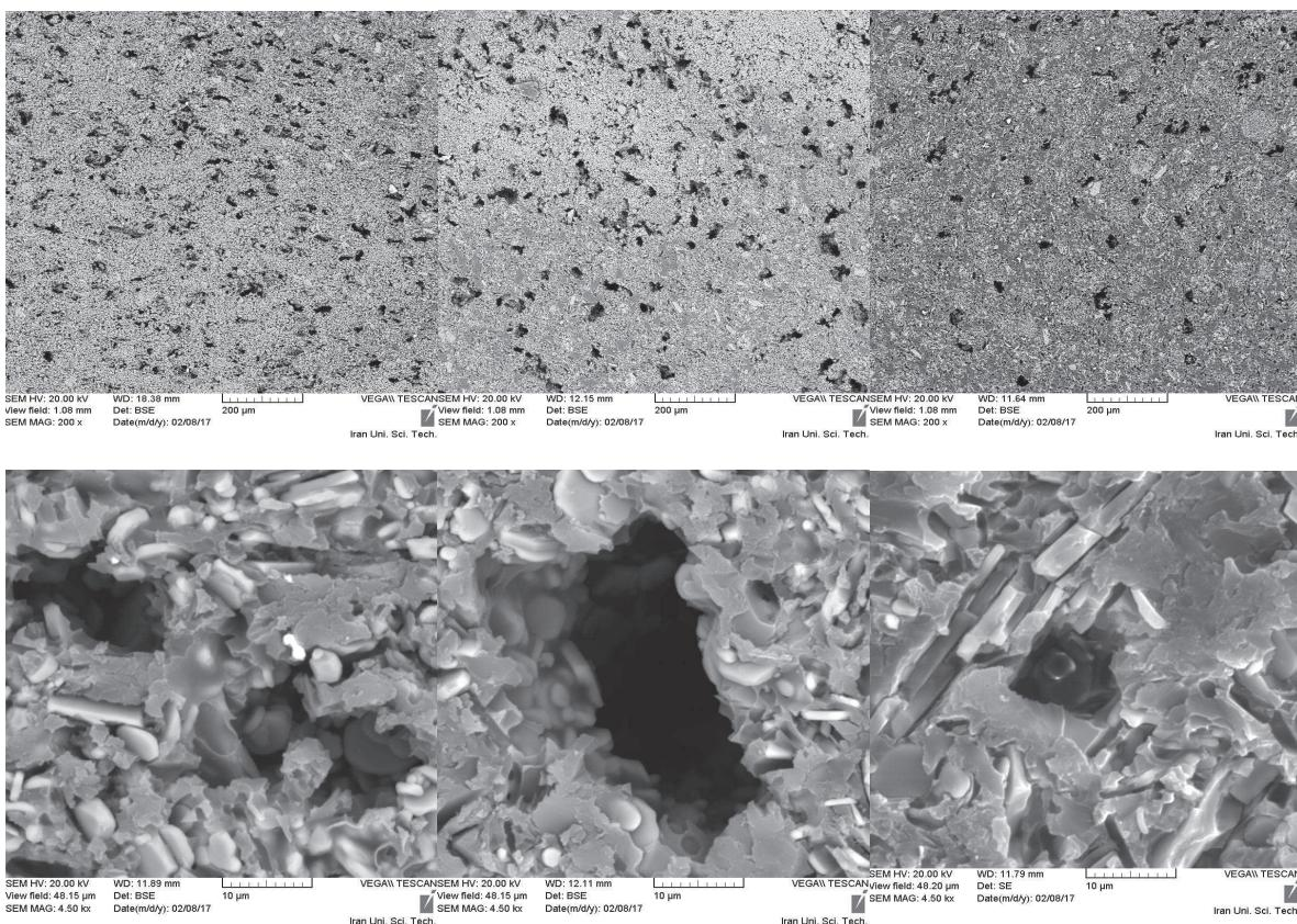
شکل ۴- تصاویر SEM - نمونه‌های (الف) A، (ب) B، (پ) C زینتر شده در دمای  $1500^{\circ}\text{C}$  (تصاویر نمونه‌ها از سطح مانت شده و در دو بزرگنمایی  $200 \times$  و  $4500 \times$  گرفته شده است).
