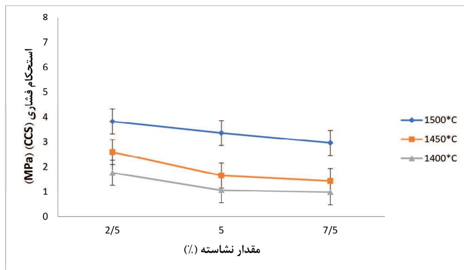
شکل ۵- استحکام فشاری نمونه‌ها بر حسب مقدار نشاسته
