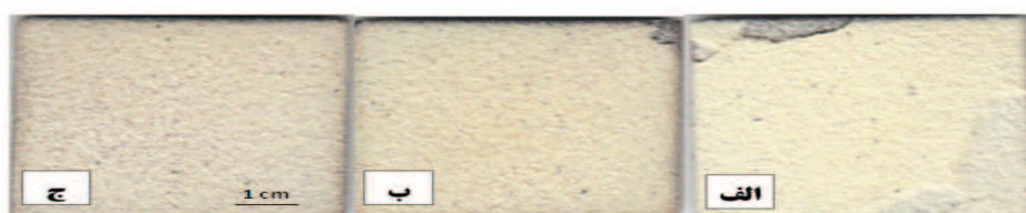
شکل ۱۰- سطح نمونه پوشش درجه‌بندی شده پس از اعمال شوک حرارتی در حالت الف) پوشش دولایه معمولی، ب) پوشش درجه بندی شده سه لایه و ج) پوشش درجه بندی شده پنج لایه
