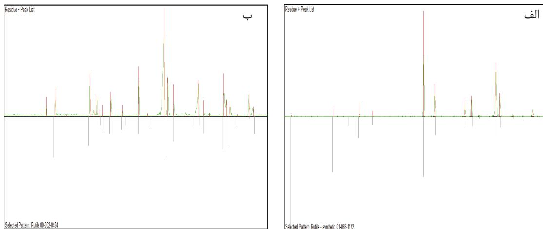
شکل ۴- مقایسه بین قله‌های مرجع و قله‌های الف: نانورنگدانه A ب: نانورنگدانه B
