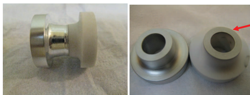
شکل ۵- نمونه استاندارد برای بررسی میزان استحکام چسبندگی لایه متالایز.
