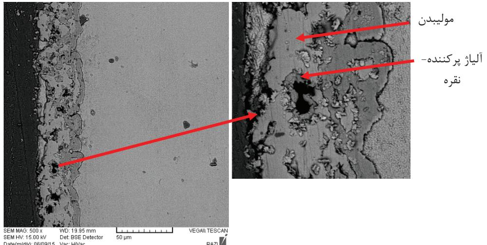
شکل ۱۰ - تصویر میکروسکوپ الکترونی روبشی از فصل مشترک اتصال نمونه‌های کشن، متالایز شده تحت دمای ۱۵۰۰ درجه سانتیگراد.
