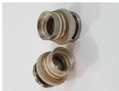
شکل ۱۱ - پوسته تفنگ الکترونی بعد از عملیات بریزینگ.
