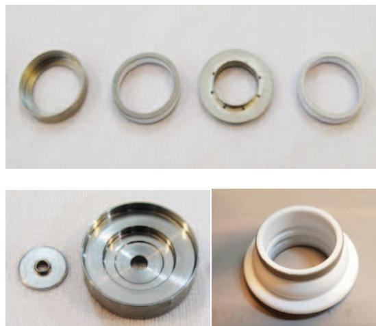
شکل ۳- قطعات ساخته شده برای تولید پوسته تفنگ الکترونی
