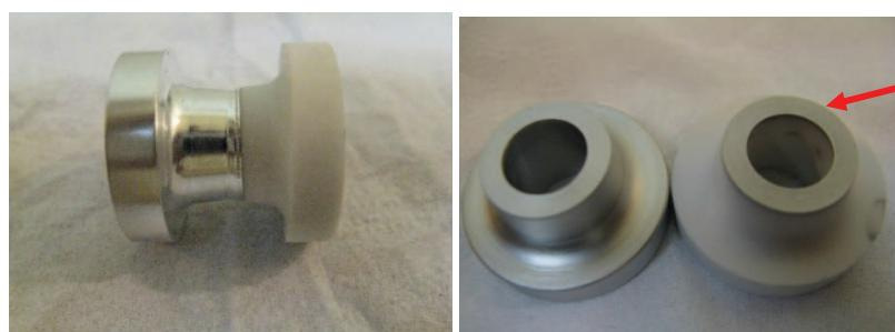
شکل ۵- نمونه استاندارد برای بررسی میزان استحکام چسبندگی لایه متالایز.
