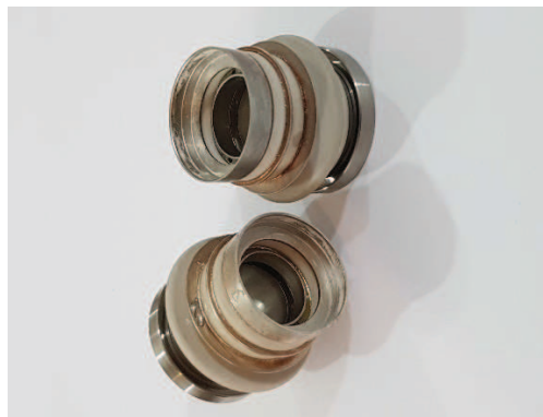
شکل ۱۱- پوسته تفنگ الکترونی بعد از عملیات بریزینگ.
