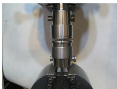
شکل ۶- آزمایش کشش برای نمونه‌های اتصال دهنده شده در شکل ۴.
