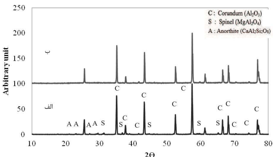
شکل ۴- پراکنش اشعه ایکس از نمونه (الف) قبل از فرآیند متالایزینگ و بعد از فرآیند متالایزینگ با سرعت سرد شدن ۱۰۰ درجه بر دقیقه از دمای ۱۵۰۰ درجه سانتیگراد (ب) بعد از فرآیند متالایزینگ با سرعت سرد شدن ۱۰۰ درجه بر دقیقه از دمای ۱۶۰۰ درجه سانتیگراد.
