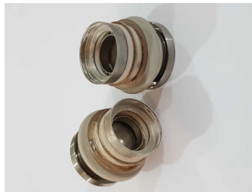
شکل ۱۱- پوسته تفنگ الکترونی بعد از عملیات بریزینگ.
