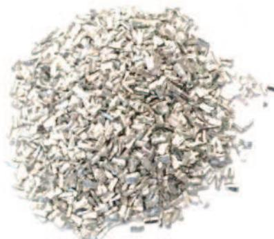
شکل ۱- براده‌های ماشین‌کاری شدهٔ آلیاژ منیزیم AZ91D
