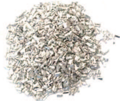
شکل ۱- براده‌های ماشین‌کاری شده‌ی آلیاژ منیزیم AZ91D
