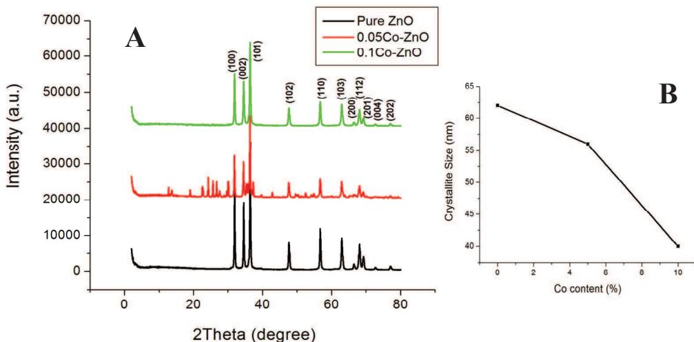
شکل ۱ - الگوهای XRD مریبوط به (A) ZnO خالص و به همراه ناخالصی (B) تغییرات اندازه ذره با درصد ناخالصی Co
