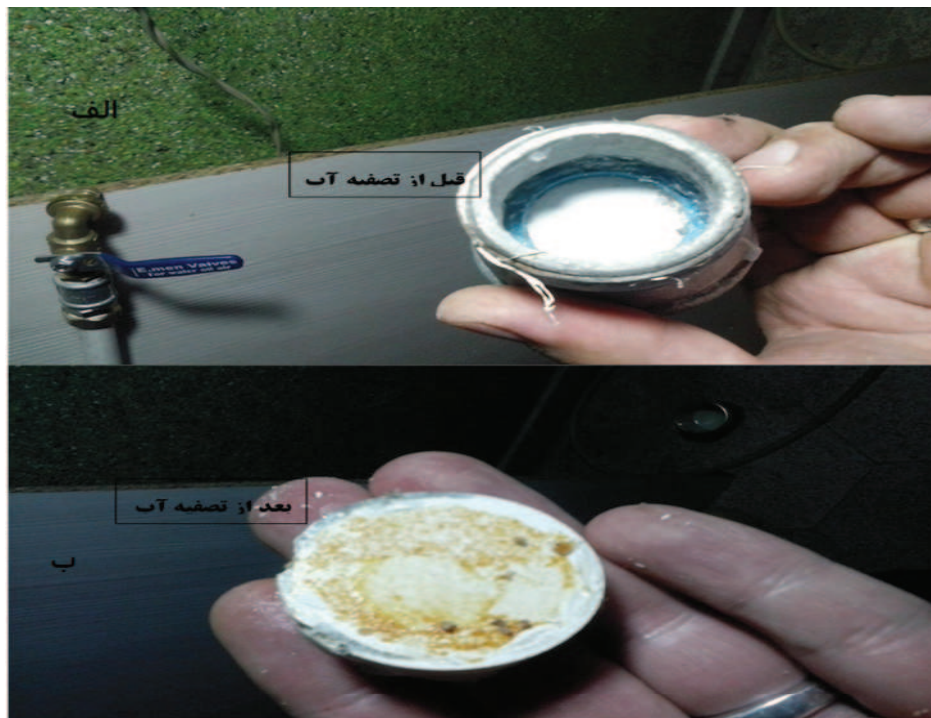
شکل ۶- غشای الف قبل و ب بعد از تصفیه آب
