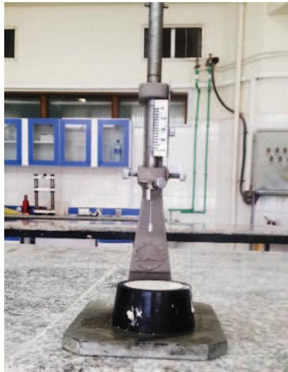
شکل ۱- دستگاه حلقه ویکات برای اندازه‌گیری زمان گیرش.
