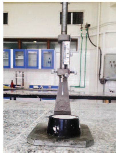
شکل ۱- دستگاه حلقه ویکات برای اندازه‌گیری زمان گیرش.
