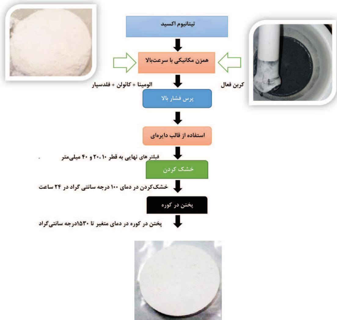
شکل ۳- شماتیک مراحل ساخت فیلترهای کامپوزیت پایه سرامیکی
