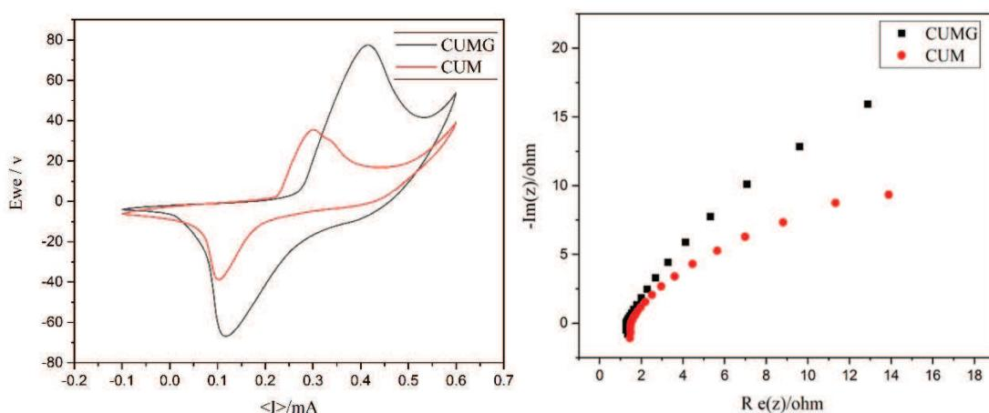
شکل ۵- (الف) منحنی نایکوییست الکترودهای CUM و CUMG در دامنه فرکانس ۱۰۰ mHZ، ۱۰۰ kHZ
