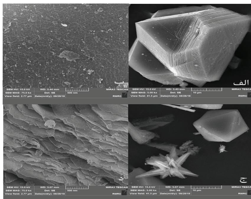
شکل ۴- آنالیز میکروسکوپ الکترونی روبشی گسیل میدانی (FESEM) نمونه‌های CUMG (الف-ب) و CUM (ج-د).
