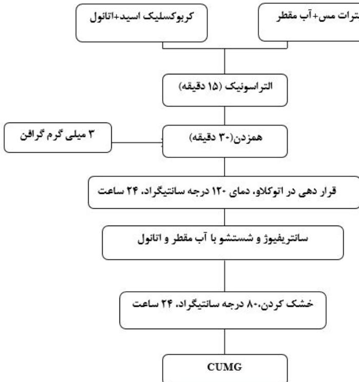
شکل ۱ - فلوچارت تهیه نانوکامپوزیت چهارچوب آلی فلزی بر پایه مس / گرافن.
