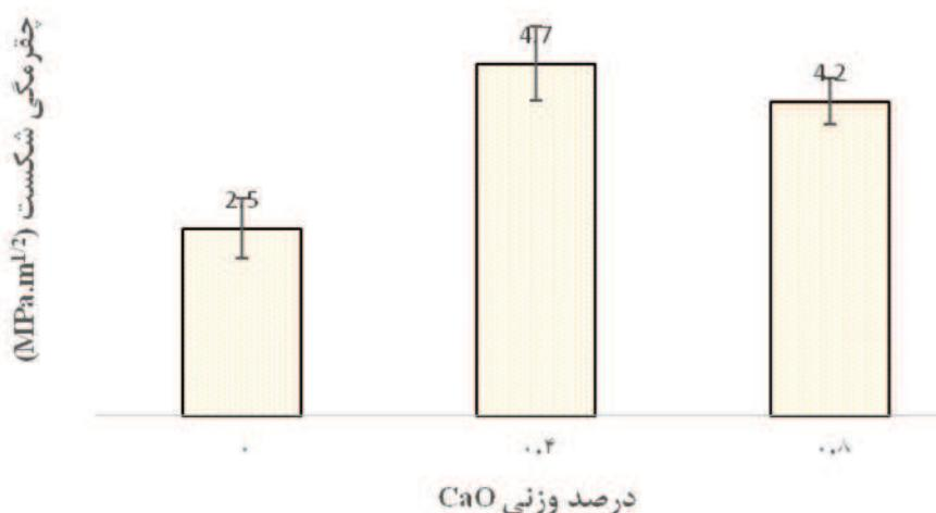
شکل ۷- تغییرات چرمگی شکست بر حسب درصد وزنی کلسیا در نمونه‌های سینتر شده توسط پودر SiC-2.
