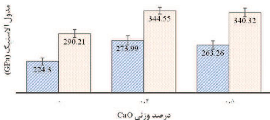
شکل ۵- تغییرات مدول الاستیک نمونه‌های سیتتر شده از دو پودر  $\text{SiC-1}$  و  $\text{SiC-2}$  در مقادیر مختلف افزودنی  $\text{CaO}$ .
