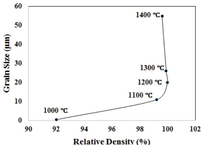
شکل ۲- اندازه دانه‌های نمونه‌های منیزیای زینتر شده در مقابل دانسیته نسبی آن‌ها در دماهای مختلف در زمان ۲۰ دقیقه با فشار اعمالی ۸۰ مگاپاسکال در طی زینتر قوس پلاسمای
