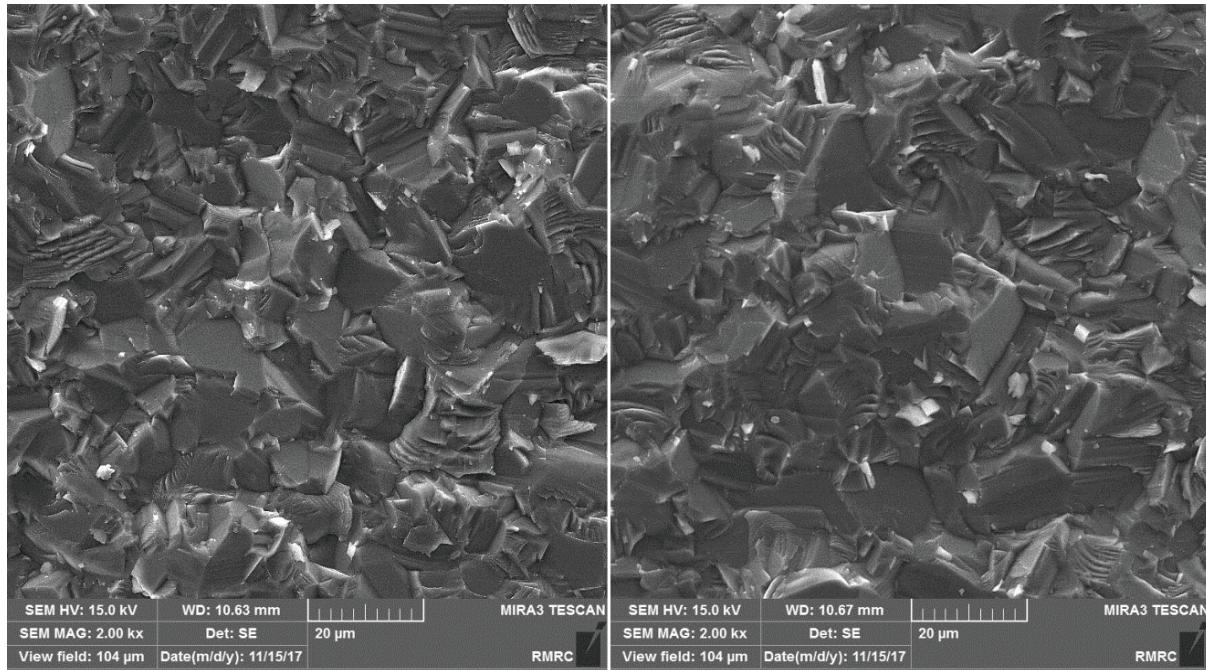
شکل ۵- تصاویر میکروسکوپ الکترونی روبشی از سطح شکست منیزیای زینتر شده در دمای  $1200^{\circ}\text{C}$
