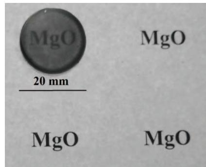
شکل ۷- تصویر تهیه شده توسط دوربین عکاسی از منیزیای زینتر شده در دمای  $1200^{\circ}\text{C}$
