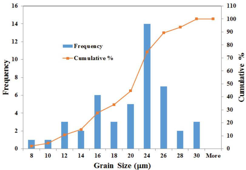
شکل ۶- توزیع اندازه دانه، فراوانی و درصد تجمعی دانه‌های موجود در سطح شکست منیزیای زینتر شده
