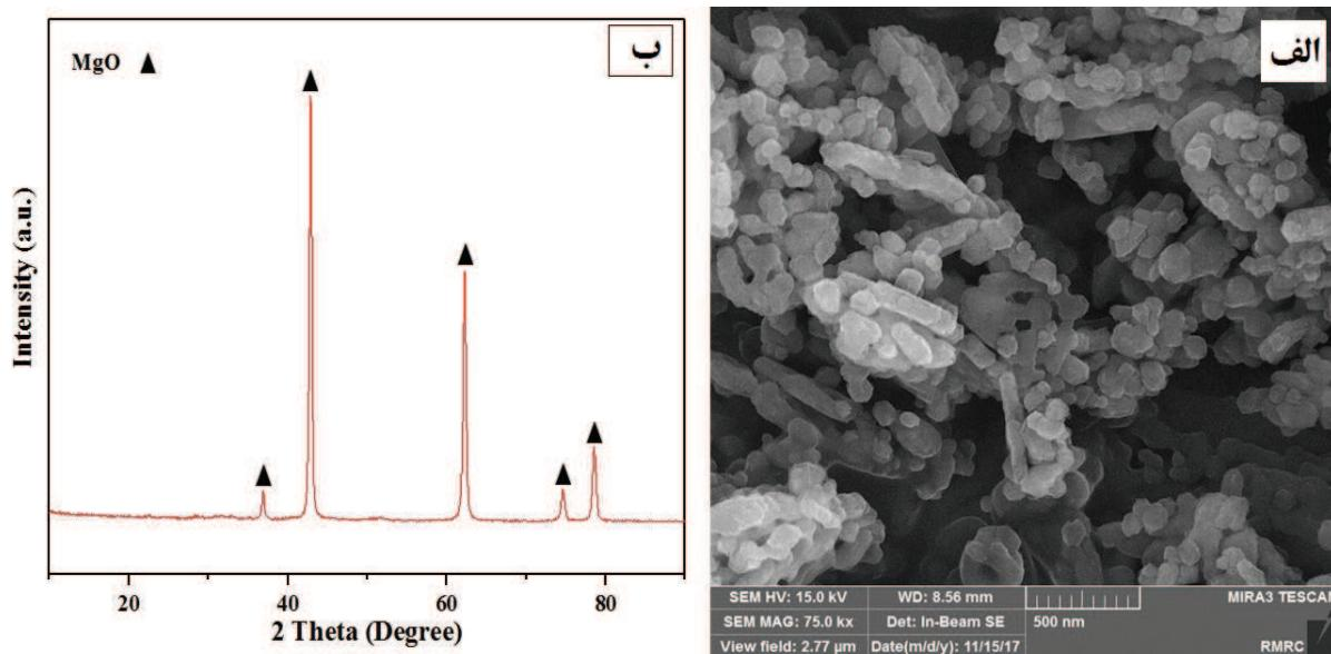
شکل ۱- (الف) تصویر میکروسکوپ الکترونی روبشی و (ب) الگوی پراش پرتو ایکس از نانوپودر منیزیای آسیاکاری شده به مدت ۱۵ ساعت در محیط اتانول و خشک شده در دمای  $100^{\circ}\text{C}$  و سپس عبور داده شده از الک با مش  $230^{\circ}$
