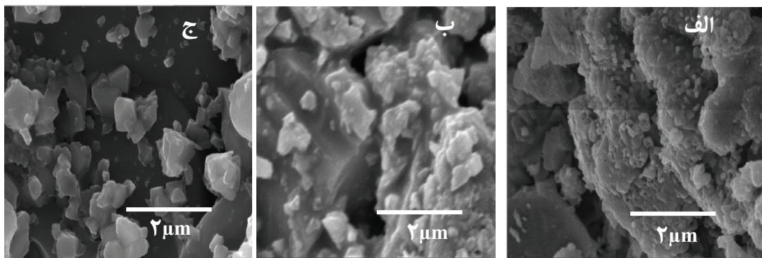
شکل ۳- تصاویر SEM پودرهای حاصل سنتز شده، (الف) A<sub>1</sub> (ب) A<sub>2</sub> (ج) A<sub>3</sub>
