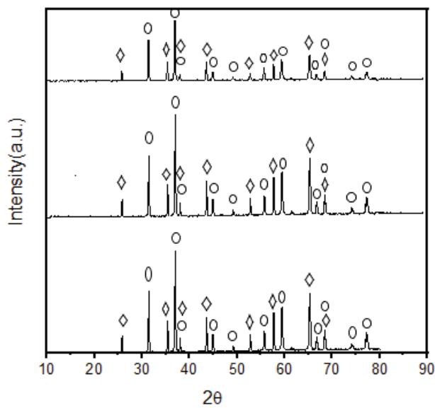
شکل ۱ - نمودار XRD پودرهای حاصل، (الف) A<sub>1</sub> (ب) A<sub>2</sub> (ج) A<sub>3</sub>
