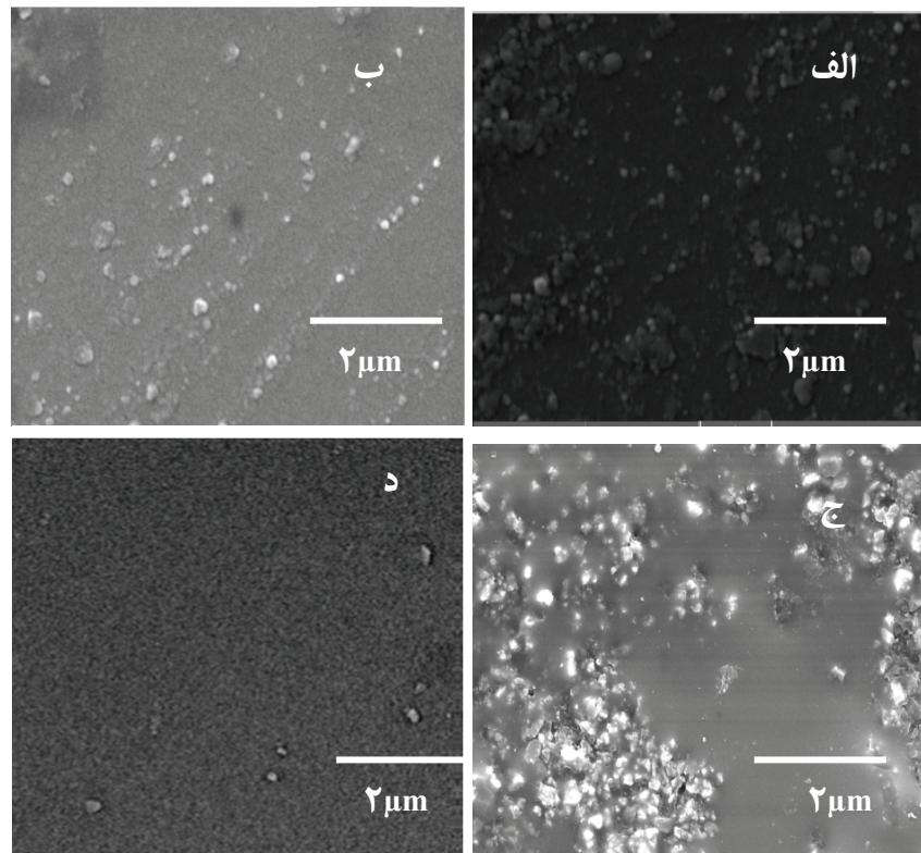
شکل ۷- تصاویر SEM نمونه‌های چاپ شده بر روی سرامیک، (الف) A<sub>1</sub> (ب) A<sub>2</sub> (ج) A<sub>3</sub> (د) بدون پوشش
