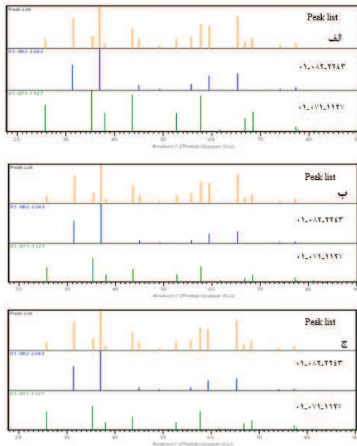
شکل ۲ - تصاویر به دست آمده از آنالیزهای XRD برای مقایسه قلهای مرجع و نمونه‌های (الف) A<sub>1</sub> (ب) A<sub>2</sub> (ج) A<sub>3</sub>
