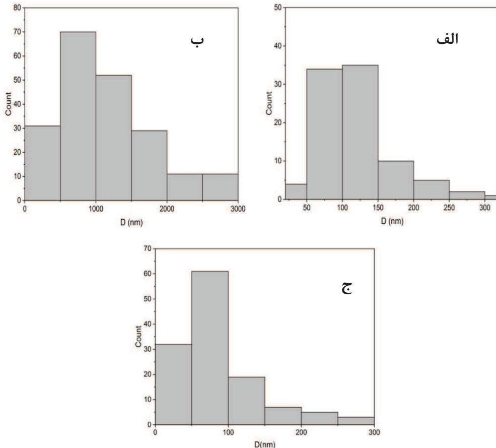
شکل ۹- نمودار توزیع فراوانی نمونه‌های چاپ شده بر روی سرامیک (الف) (ب) (ج) A<sub>1</sub>, A<sub>2</sub>, A<sub>3</sub>
