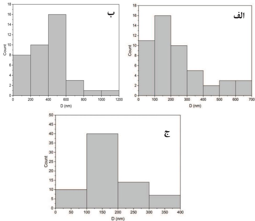
شکل ۴- نمودار توزیع فراوانی تعداد ذرات بر حسب قطر آنها برای نمونه‌های (الف) A<sub>1</sub> (ب) A<sub>2</sub> (ج) A<sub>3</sub>
