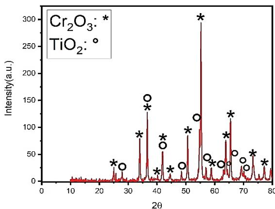
شکل ۲- الگوهای پراش اشعه ایکس از پودرهای (الف) رنگدانه S، (ب) رنگدانه T
