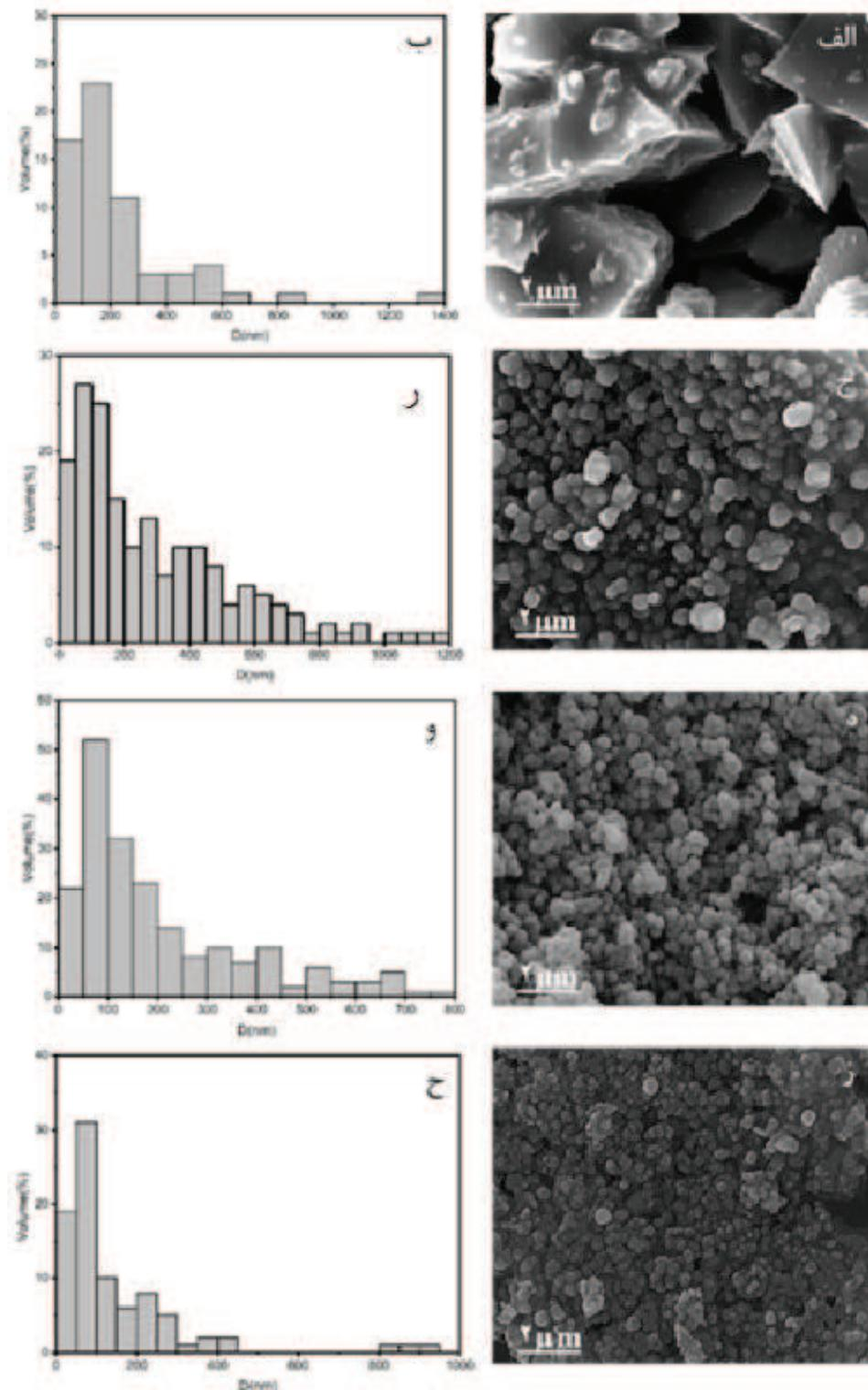
شکل ۱- تصاویر SEM: (الف) پودر سیلیکا، (ج) رنگدانه S، (د) پودر تیتانیوم دی اکسید، (ز) رنگدانه T و نمودارهای توزیع اندازه ذرات: (ب) پودر سیلیکا، (ر) رنگدانه S، (و) پودر تیتانیوم دی اکسید، (ح) رنگدانه T
