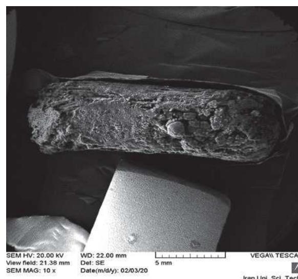
شکل ۵- تصویر SEM از سطح مقطع جانبی نمونه بعد از تست فرسایش
