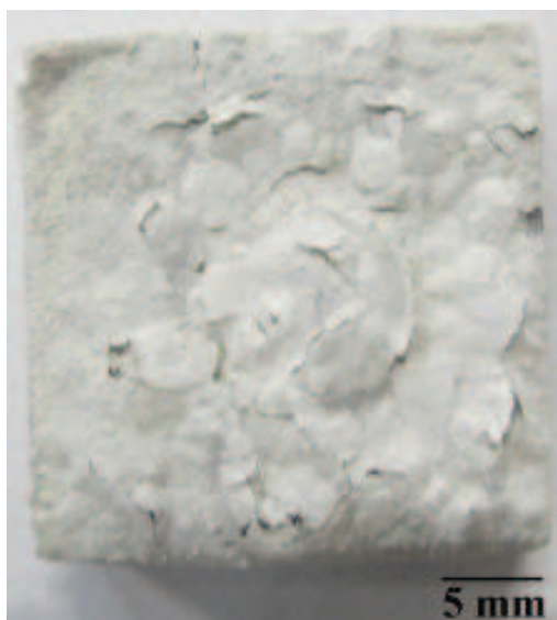
شکل ۱۰ - تصویر ماکروسکوپی از نمونه با پوشش SiC /ZrB 2 پس از آزمون رفتگی
