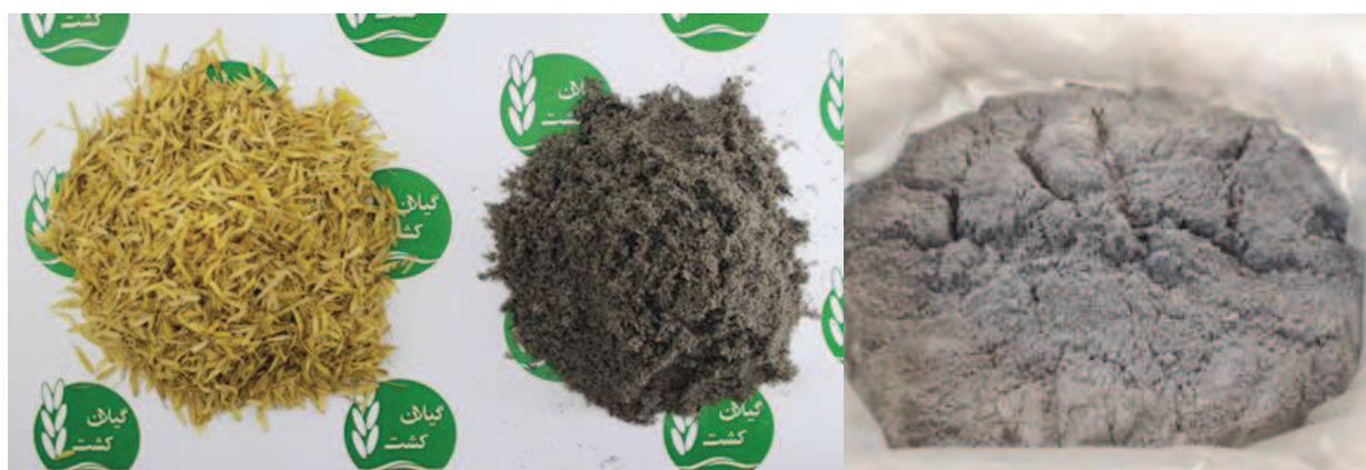
شکل ۱- از چپ تصویر پوسته‌ی برنج قبل از سوختن، خاکستر پوسته‌ی برنج آسیاب‌نشده و خاکستر آسیاب‌شده
