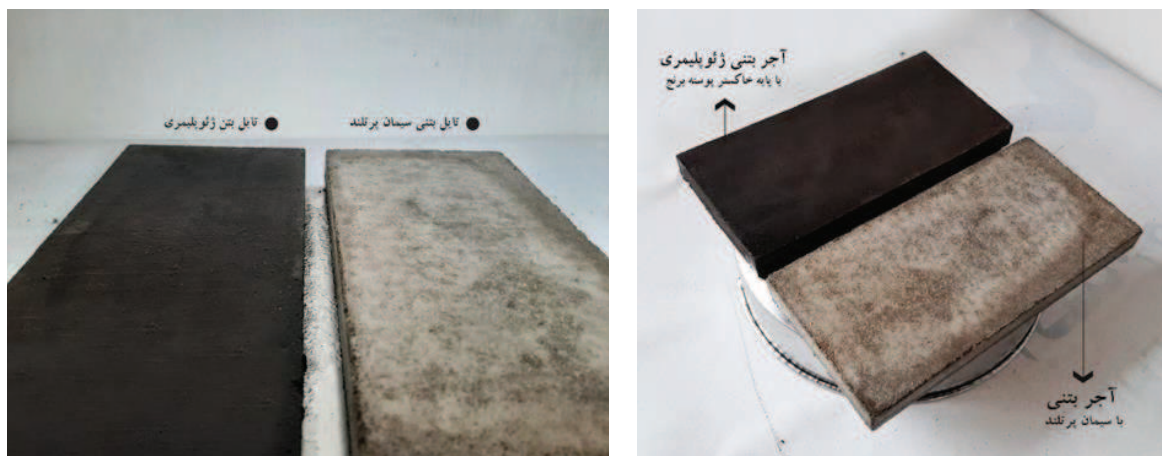
شکل ۸- آجرنمای بتن ژئوپلیمری با پایه خاکستر پوسته برنج در کنار آجرنمای بتنی با سیمان پرتلند
