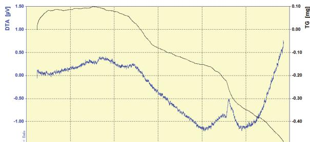
شکل ۲- آنالیز حرارتی (STA) نمونه 1G با سرعت گرم کردن  $10^{\circ}\text{C}/\text{min}$
