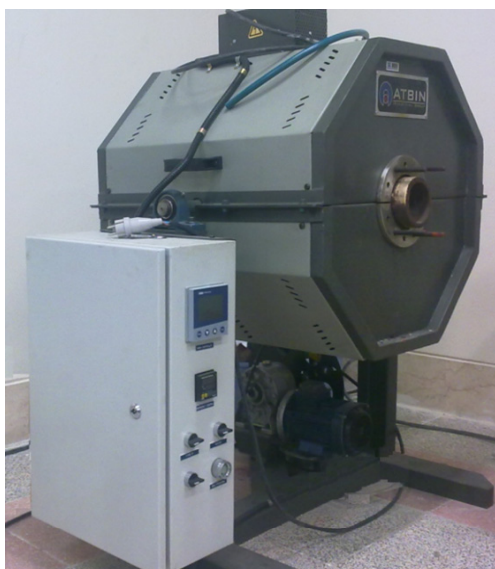
شکل ۲- نمایی از کوره‌ی لوله‌ای با حرکت رفت و برگشتی مورد استفاده در انجام ذوب و یکنواخت‌سازی شیشه‌های کالکوژنیدی
