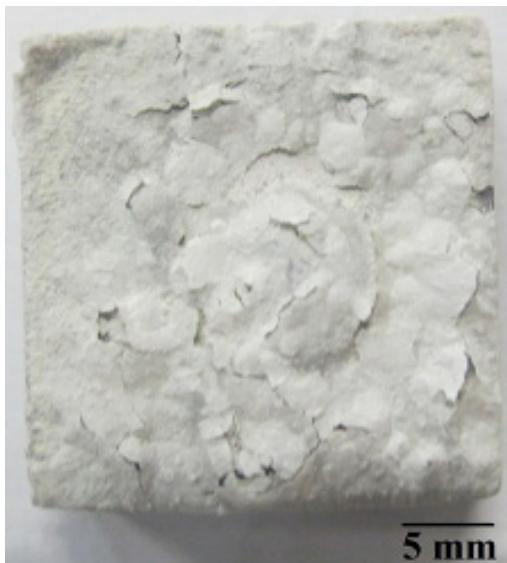
شکل ۱۰ - تصویر مکروسکوپی از نمونه با پوشش SiC/ZrB<sub>2</sub> پس از آزمون رفتگی
