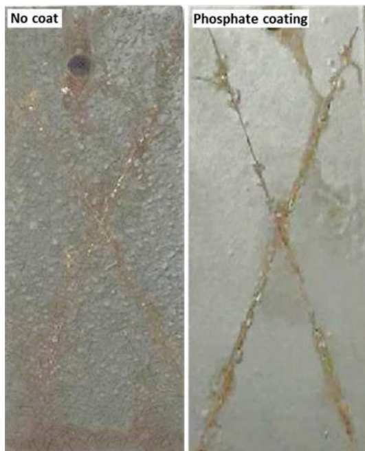
شکل ۱۶- تصاویر سطح نمونه‌های فسفات‌ه و رنگ‌شده پس از ۲۴۰ ساعت آزمایش پاشش نمک
