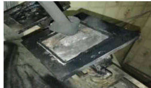
شکل ۱۲- تصویر قرارگیری نمونه در دستگاه آزمون اکسیداسیون
