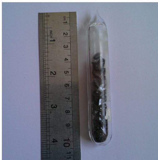
شکل ۱- نمایی از کپسول کوارتز مورد استفاده در ساخت شیشه‌های کالکوزنیدی
