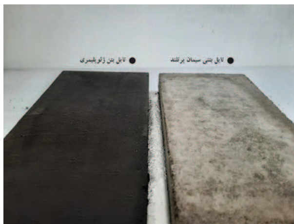
شکل ۸- آجرنمای بتن ژئوپلیمری با پایه خاکستر پوسته برنج در کنار آجرنمای بتنی با سیمان پرتلند
