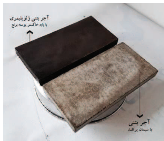
شکل ۸- آجرنمای بتن ژئوپلیمری با پایه خاکستر پوسته برنج در کنار آجرنمای بتنی با سیمان پرتلند
