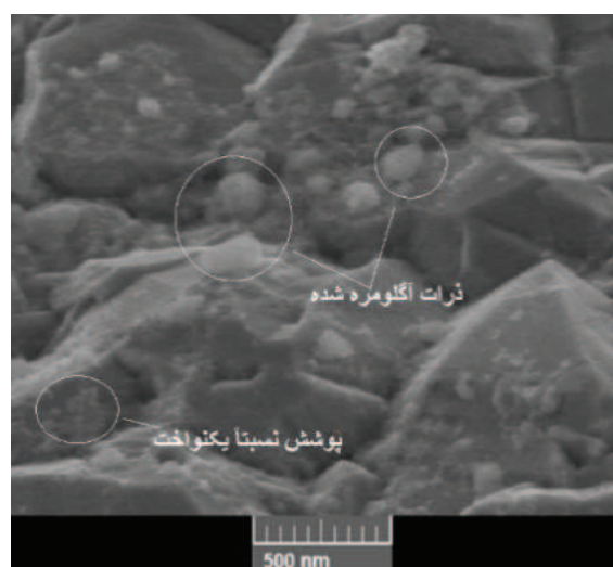
شکل ۶- پوشش \text{TiO}_2 black روی فوم مسی آندایز شده
