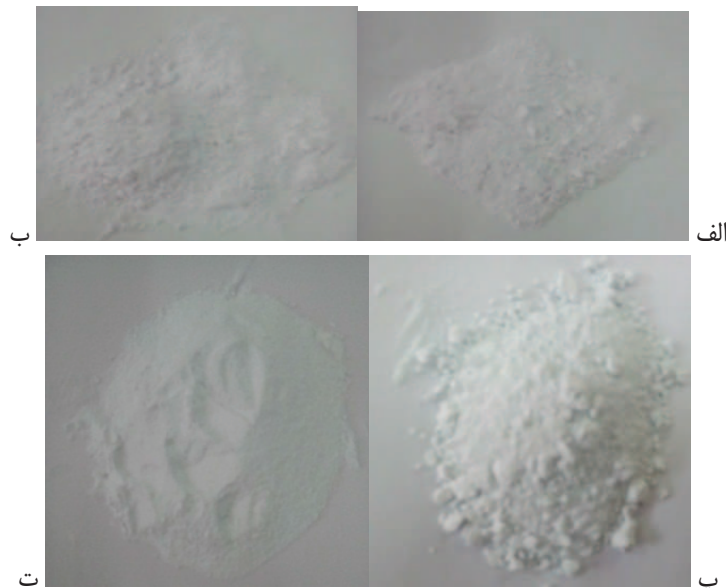
شکل ۱- الف) پودر خالص ب) پودر آسیاب‌کاری شده به مدت ۲۰ ساعت پ) پودر کلسینه شده در دمای ۶۰۰ درجه سانتیگراد به مدت ۲ ساعت ت) پودر عبور داده شده از الک با مش ۲۰۰
