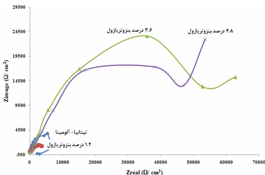
شکل ۶- نمودار نایکویست مربوط به پوشش تیتانیا-آلومینا در حضور غلظت‌های مختلف بنزوتریازول و عدم حضور بنزوتریازول.
