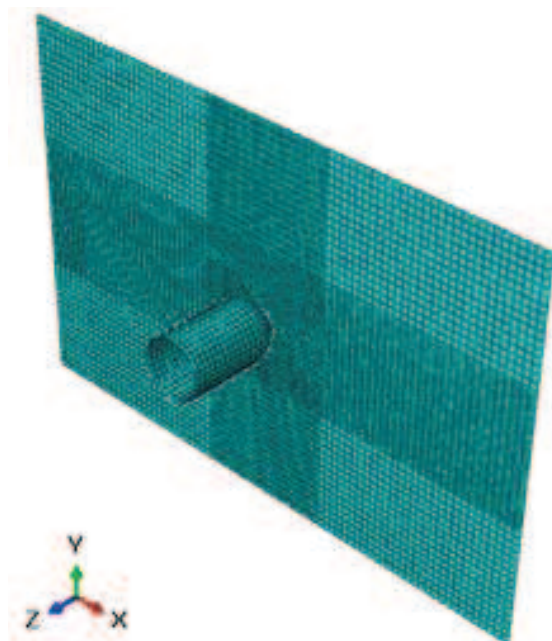
شکل ۴- نمای مونتاژی از پرتابه و کامپوزیت
