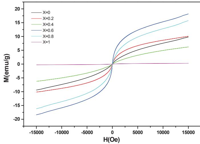
شکل ۵- نمودار حلقه پسماند نانوذرات  $\text{Ca}_{1-x}\text{Mg}_x\text{Fe}_2\text{O}_4$  به صورت تجمعی
