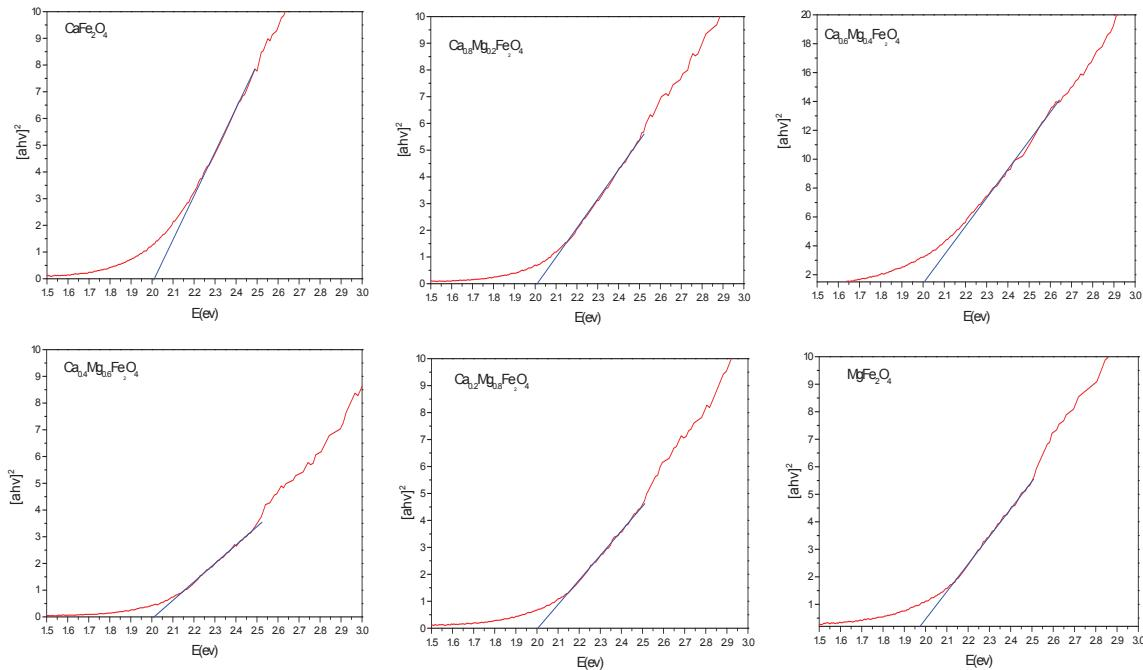
شکل ۷- نمودار مربوط به گاف انزی نانوذرات فریت  $\text{Ca}_{1-x}\text{Mg}_x\text{Fe}_2\text{O}_4$
