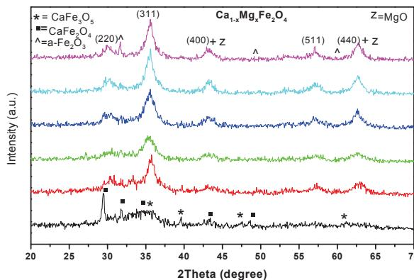
شکل ۲- نمودار پراش پرتو ایکس نانو ذرات ترکیبی  $\text{Ca}_{1-x}\text{Mg}_x\text{Fe}_2\text{O}_4$  به صورت تجمعی
