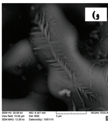
شکل ۲- ریزساختار نمونه‌ها پخت شده در کوره تونلی، الف) 1680-ZM1، ب) 1680-ZM2، ج) 1680-ZM3، د) 1680-ZM3، و) 1680-ZM4. دانه‌های مدور مکعبی زمینه همراه با دوقلوبی‌های مونوکلینیک با طول ۲ میکرومتر مشاهده می‌گردد. لازم به ذکر است با افزایش درصد منیزیا از شدت دوقلوبی‌های مونوکلینیک کاسته شد.
