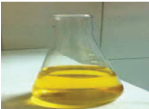
شکل ۱- (الف) محلول تیتانیوم ایزوپروپوکسید و کلریدریک و (ب) ژل پس از ۴ ساعت چرخش در همزن مغناطیسی
