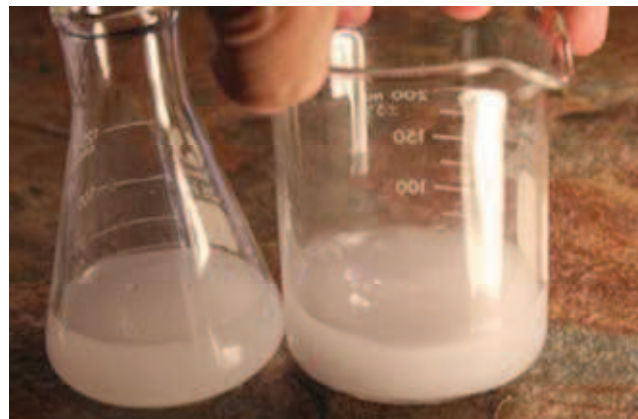
شکل ۱- (الف) محلول تیتانیوم ایزوپروپوکسید و کلریدریک و (ب) ژل پس از ۴ ساعت چرخش در همزن مغناطیسی
