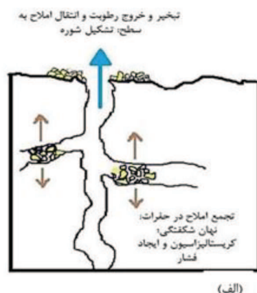
شکل ۷- (الف) طرح ترسیمی از شکل‌گیری شوره در سطح و نهان شکستگی‌ها در حفرات داخلی یک شیء متخلخل از منظر میکروسکوپی و ایجاد تنش ناشی از کریستالیزاسیون به دیواره حفرات. (ب) طرح ترسیمی از کریستال تشکیل شده در یک حفره استوانه‌ای شکل (براساس [۲۰]).
