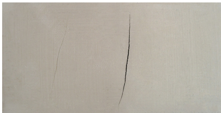
شکل ۱۲- ایجاد ترک در مرکز قطعه (راست) و توزیع تنش (سمت چپ) در دمای ۵۵ درجه
