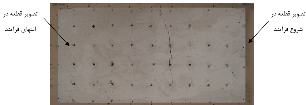
شکل ۱۰- منطبق نمودن ۲ تصویر مربوط به ابتدا و انتهای فرآیند خشک کردن در دمای ۳۵ درجه
